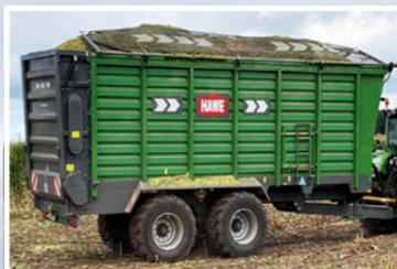
**Hawe Cover** La couverture automatique de la caisse pour un transport sur route en toute sécurité et sans perte de chargement. (en option)
