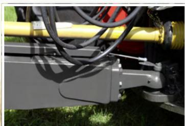
**Liaison au guidage forcé par câble Bowden.**
