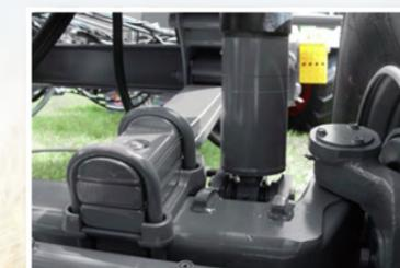
Essieu avec **suspension hydro-pneumatique.**
