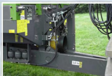
**Béquille hydraulique et flèche à suspension hydropneumatique.**
