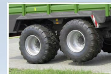
**Essieu relevable** pour augmenter la puissance de traction si nécessaire et réduire la résistance au roulement sur route.
